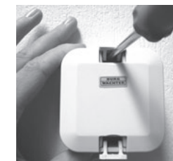
Fig. 5 : serrage des vis de l'extendeur transpondeur
