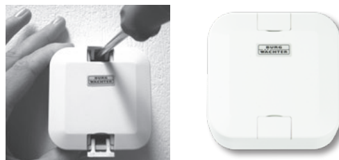
Fig. 10 : monter l'extendeur transpondeur
