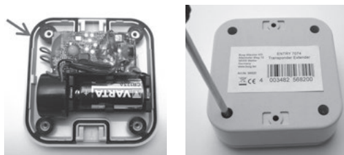
Fig. 9 : fermeture de l'extendeur transpondeur
