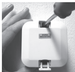
Fig. 7 : démontage de l'extendeur transpondeur
