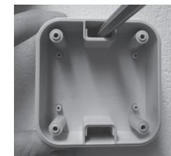
Abb. 3: Bohrposition anzeichnen
