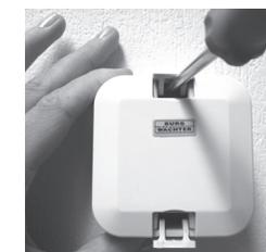
Abb. 5: Verschrauben des Transponder Extenders
