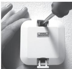
Abb. 7: Lösen des Transponder Extenders
