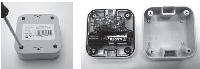
Abb. 8: Öffnen des Transponder Extenders
