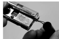
6 Montagehilfe auf den Stecker schieben und zusammen mit dem Zylinder und dem Adapter von innen in das Einsteckschloss schieben.
