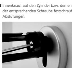
3 Innenknopf auf den Zylinder bzw. den entsprechenden Adapter stecken und mit der entsprechenden Schraube festschrauben. Tabelle 1 liefert die entsprechenden Abstufungen.
