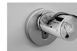
12 Kabel stramm halten und durch die Nut führen.
