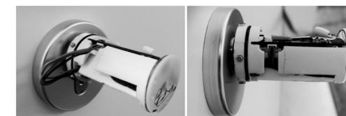
15 Batterie entsprechend der Polung einsetzen und die Hülse einrasten.
