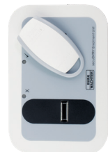
Image 2 : Placement de lecture du transpondeur
