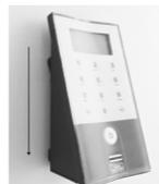
**Achtung!** Vermeiden Sie, dass Feuchtigkeit beim Batteriewechsel in die Tastatur gelangt.
