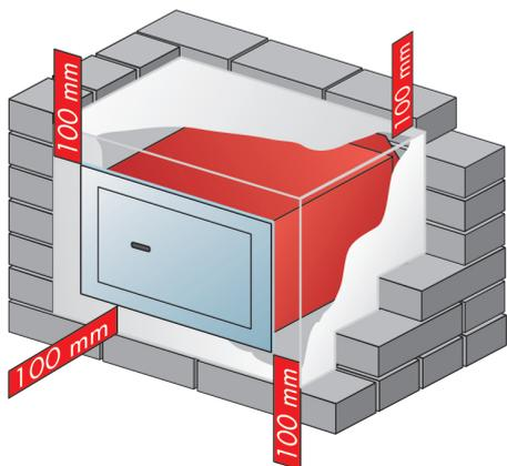
**Atenção:** Se o cofre-forte for instalado numa parede exterior, pode surgir condensação devido à diferença de temperaturas. Neste caso, o cofre-forte deverá ser isolado. Não aceitamos nenhuma responsabilidade por uma instalação incorreta nem por danos causados pela condensação.
