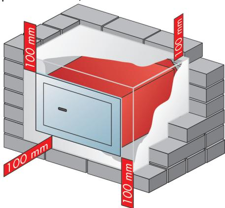
**Помните:** При строительстве наружных стен может из-за разницы температур происходить осаждение воды. Поэтому сейф следует соответствующим способом изолировать. За ущерб, причиненный осажденной водой и непрофессиональным монтажом, мы не несём никакой ответственности.
