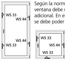
Según la norma DIN 18104-1, cada 1 m de altura de ventana debe montarse en cada lado al menos un seguro adicional. En el lado de accionamiento (lado de la manija) se debe poder cerrar al menos un seguro adicional.
