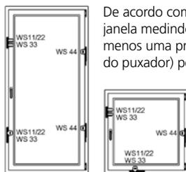
De acordo com a norma DIN 18104-1 cada altura de janela medindo 1m deve ter montada em cada lado, pelo menos uma proteção adicional. No lado de atuação (lado do puxador) pelo menos uma segurança adicional deve ser bloqueável.
