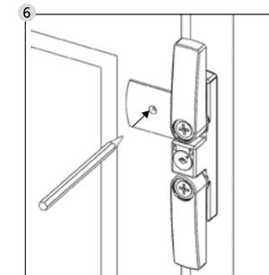
Girare la levetta lateralmente e segnare con una matita il punto per realizzare il foro nel rivestimento in lamiera dell'anta.
