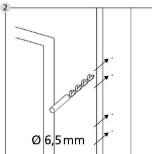
Evidenziare meglio i segni fatti con una matita ad es. con una vite appuntita e martello, dopodiché realizzare i 4 fori servendosi della punta di  $\varnothing$  6,5. **Non attraversare tutto il telaio della finestra.**
