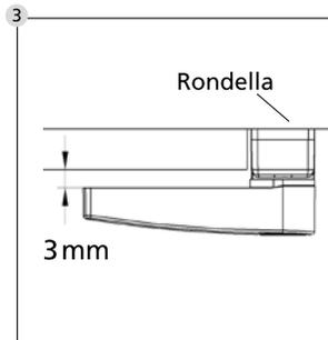
Inserire gli spessori forniti sotto il blocca finestra affinché tra la levetta e l'anta della finestra si crei una fessura di ca. 3 mm.
