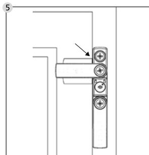
Centrare il rivestimento in lamiera dell'anta sotto la levetta, allinearlo con il bordo dell'anta e tenerlo fermo.
