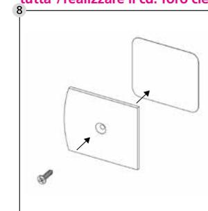
Incollare lo spessore adesivo bifacciale sul lato posteriore del rivestimento in lamiera dell'anta. Sul lato anteriore deve essere visibile la cavità per la testa della vite svasata. Lo spessore adesivo bifacciale deve essere forato utilizzando la vite a testa svasata di  $\varnothing 2,9 \times 13$ .
