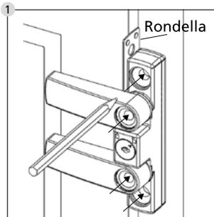
Utilizzando la chiave fornita aprire il blocca finestra dopodiché estrarre la chiave. Girare entrambe le levette lateralmente e tenere il blocca finestra sul telaio della finestra in posizione desiderata. Utilizzando **lo spessore di 1 mm** creare un distacco dall'anta della finestra e segnare con una matita 4 punti per realizzare i fori.
