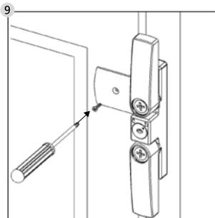
9 Attaccare il rivestimento in lamiera allineato rispetto all'anta della finestra e inserire la vite di  $\varnothing 2,9 \times 13$ .
