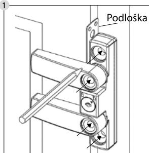
Pomoću priloženog ključa sigurnosni element prozora otvorite i izvadite ključ. Obje sklopive poluge okrenite na stranu, a sigurnosni element držite na okviru prozora u traženom položaju. Pomoću **podloške debljine 1 mm** napravite razmak od krila prozora i olovkom označite 4 mjesto za bušenje.
