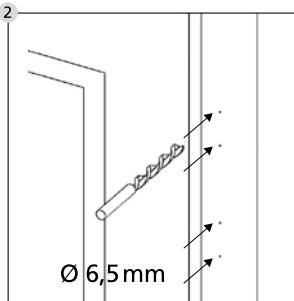
Oznake blago istaknite, npr. pomoću vrha vijka/čekića i svrdlom promjera Ø 6,5 izbušite 4 otvora.
