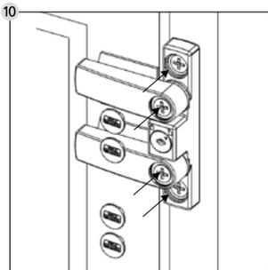
10 Coloque las cubiertas en los agujeros de los tornillos.
