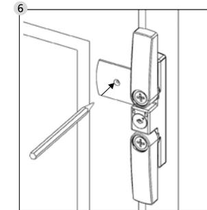
Gire la palanca giratoria un lado y marque la posición de perforación de la placa de hoja con un lápiz.
