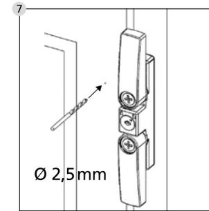
Profundice la marca ligeramente con, p. ej., la punta de un tornillo/martillo y taladre el agujero con un taladro de Ø 2,5.
