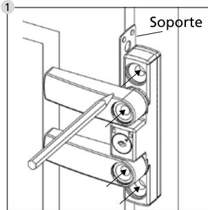
Abra el seguro de ventana con la llave adjunta y retire la llave. Gire las dos palancas giratorias hacia un lado y mantenga el seguro de ventana en el marco de la ventana en la posición deseada. Mantenga una distancia a la hoja de la ventana con un **soporte de un espesor de 1 mm** y marque las 4 posiciones de taladrado con un lápiz.
