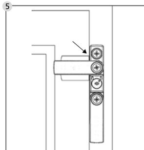
Coloque una placa de hoja centrada debajo de la palanca giratoria y al ras con el borde de la hoja de la ventana y manténgala fija.
