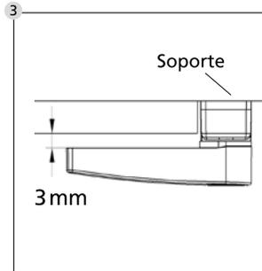
Apoyar el seguro de ventana con los soportes adjuntos hasta alcanzar una distancia de unos 3 mm entre la palanca giratoria y hoja de la ventana.
