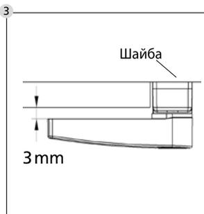
Положите под оконную защёлку прилагаемые шайбы таким образом, чтобы между рычагом и створкой был зазор около 3 мм.
