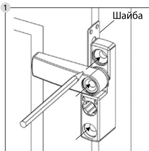
Используя имеющийся в комплекте ключ, откройте оконную защёлку и выньте ключ из замка. складной рычаг поверните в сторону и придержите оконную защёлку на раме в необходимом положении. Используйте **прокладку толщиной в 1 мм**, чтобы создать расстояние от створки, и карандашом отметьте 3 места для сверления.
