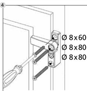
Установите оконную защёлку с помощью выбранных шайб и прилагающихся винтов. **Не допускайте перекручивания винтов.**
