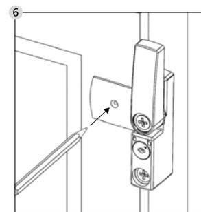
Поверните складной рычаг в сторону и карандашом отметьте место для отверстия в накладке створки.
