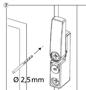
Метки необходимо слегка выделить, например, используя кончик винта / молотка, и сверлом Ø2,5 высверлить отверстие.
