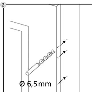
Метки следует слегка выделить, например, острием винта / молотка, и сверлом с Ø6,5 высверлить 3 отверстия. **Раму окна не просверлить.**
