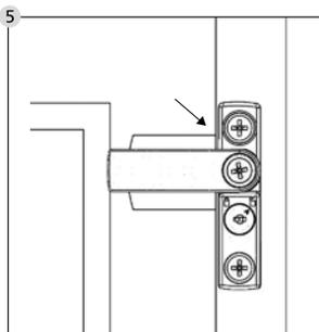
Установите металлическую накладку на створку посередине под складной рычаг, выровняйте с кромкой оконной створки и придержите.
