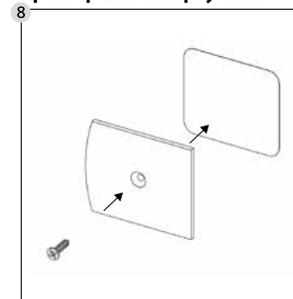
Двустороннюю клейкую прокладку наклеить на заднюю сторону наклейки на створку. На лицевой стороне должно быть видно углубление для головки винта. Клейкую прокладку проколите винтом с потайной головкой Ø 2,9x13.
