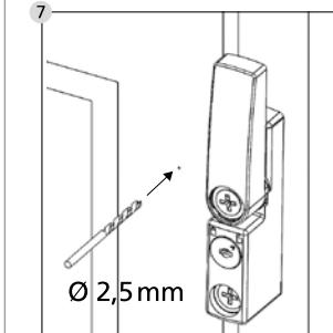
Oznake blago istaknite npr. pomoću vrha vijka/čekića i svrdlom promjera Ø 2,5 izbušite otvor.
