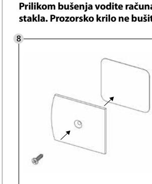
**Prilikom bušenja vodite računa da ne oštetite pokretnе dijelove, brtve ili stakla. Prozorsko krilo ne bušite.**
