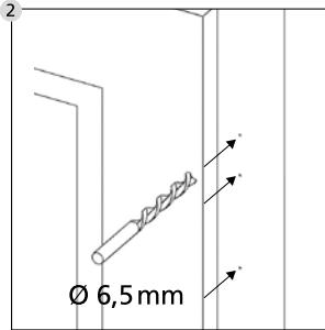
Oznake blago istaknite, npr. pomoću vrha vijka/čekićem i svrdlom promjera Ø6,5 izbušite 3 otvora.
