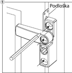
Pomoću priloženog ključa sigurnosni element prozora otvorite i izvadite ključ. Sklopivu polugu okrenite na stranu, a sigurnosni element držite na okviru prozora u traženom položaju. Pomoću **podloške debljine 1 mm** napravite razmak od krila prozora i olovkom označite 3 mjesto za bušenje.
