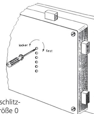
Beiliegenden Kreuzschlitz-Schraubenzieher Größe 0 verwenden
