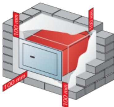
**Zur Beachtung:** Bei Einbau in Außenwände kann durch Temperaturdifferenzen Schwitzwasser auftreten. Der Tresor muss dann entsprechend isoliert werden. Bei Folgeschäden durch Schwitzwasser und unsachgemäßem Einbau übernehmen wir keine Haftung.
